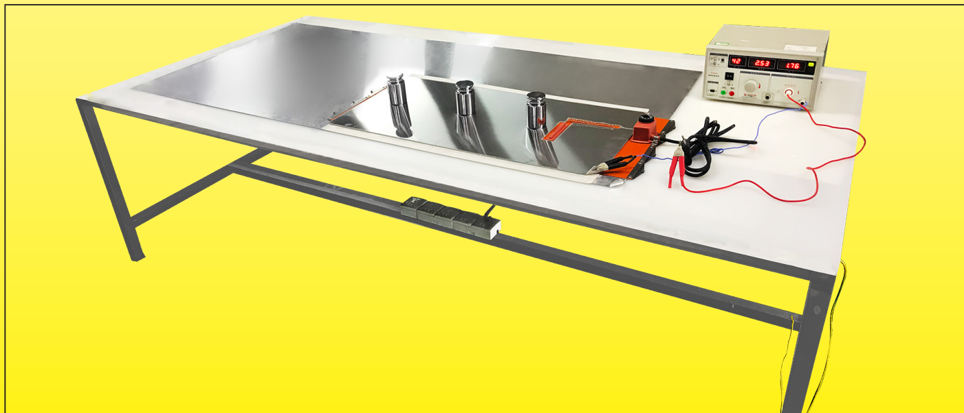
Messgeräte für den Gesamtleckstrom im kalten Zustand
